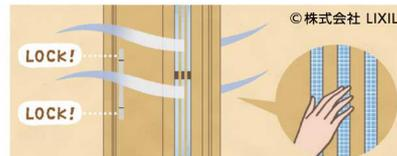
採風部分は網戸がついているので虫が気になる夏場も安心。ドアのカギを開けたままで採風でき、採風部分は外から手を差し込めないデザインで防犯性にもしっかり配慮しています。
